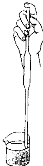
Hình 2.4. Cách sử dụng pipet
